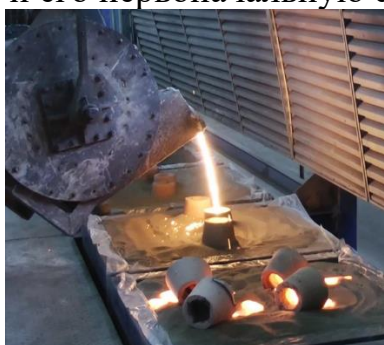
Рисунок 1. Процесс литья по газифицируемым моделям
