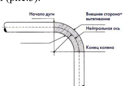
Рисунок 3 - Изменение формы трубы в результатегиба
